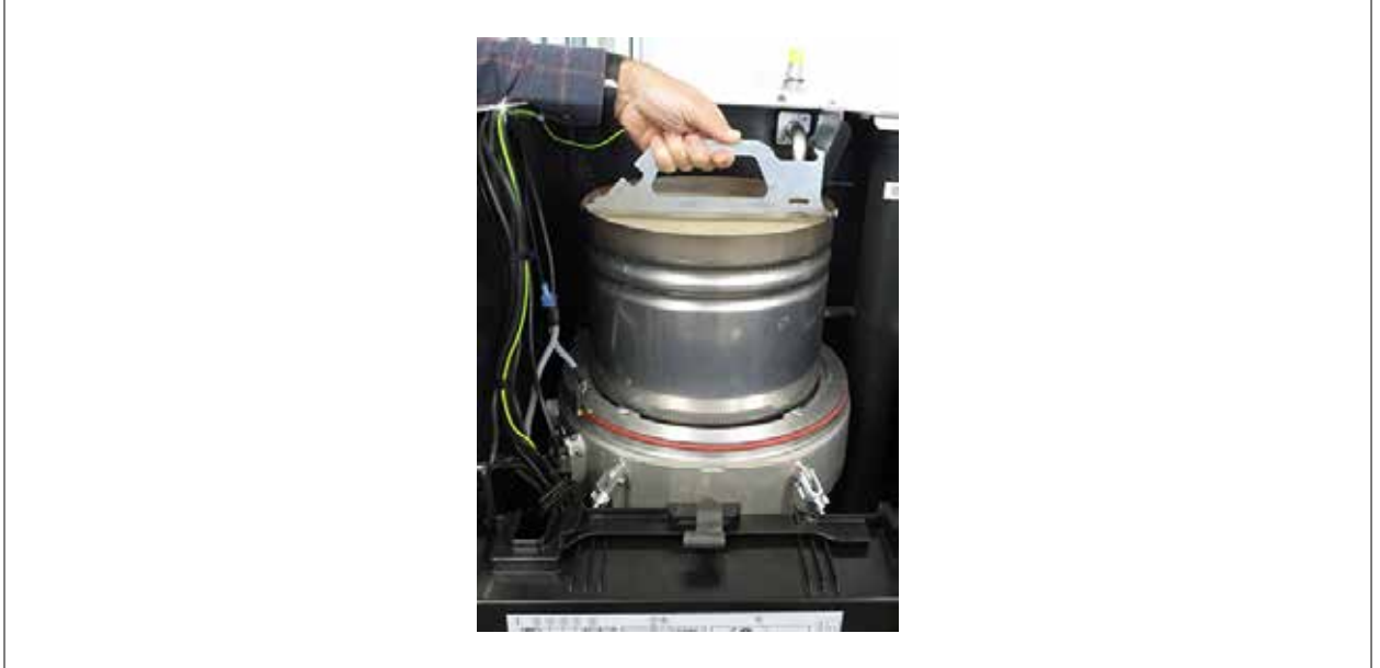
Abb. 5.17 Oberen Verdränger herausziehen
